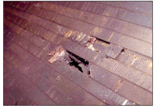
شکل ۱۴: ضایعه موتوری در خشک کن، علت شل شدن پیم
